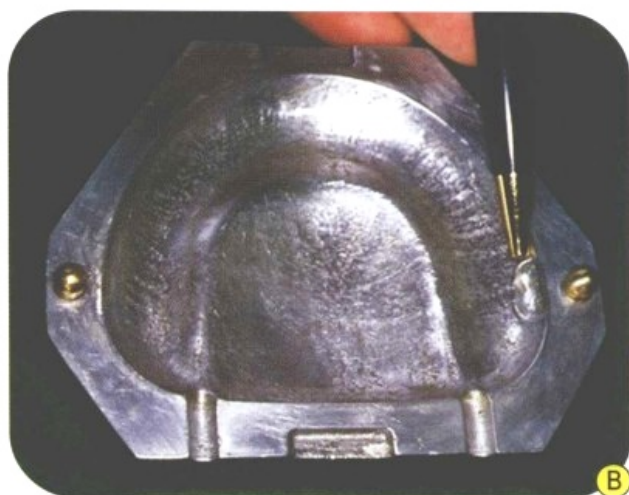
图 7-5 如果有接触阻挡部分,这部分应被削去
