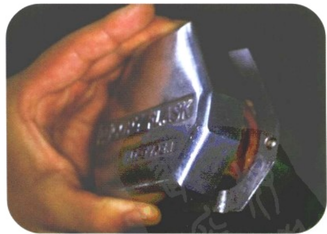
图 7-4 确认型盒能否完全复位
