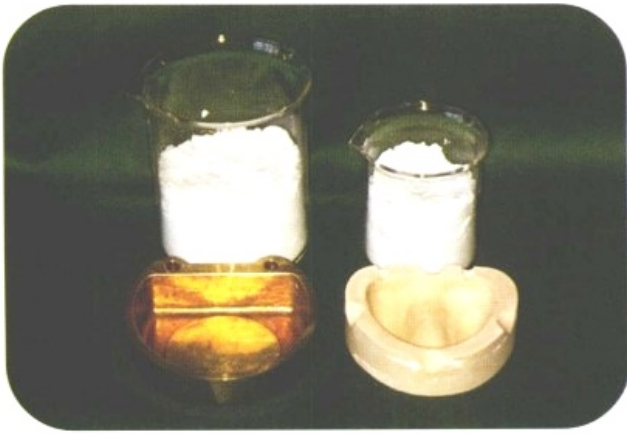
图 7-24 普通的义齿基托材料聚合用型盒与作者开发的型盒相比较,所需印模材料的比例为 2:1
