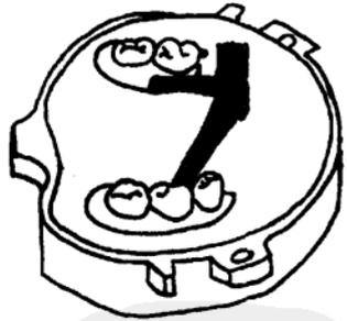
图 3-3-8-1 弹性义齿铸道安放
