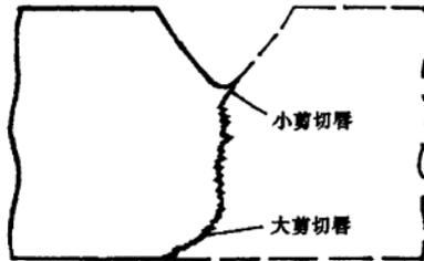
图 2-3-1-8 疲劳断口纵断面示意图
